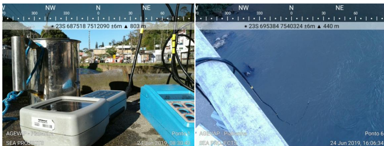
Figura 3.2-1 (esquerda): Sonda multiparamétrica e turbidímetro utilizados nas medições de campo. Figura 3.2-2 (direita): Sonda multiparamétrica mensurando os parâmetros de campo no centro do rio.
