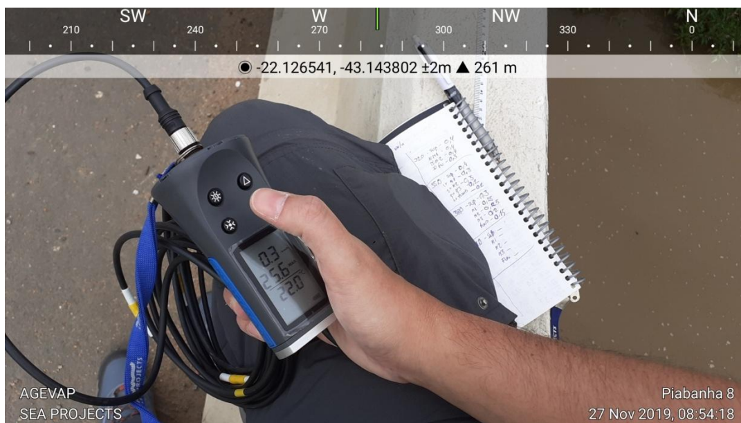
Figura 3.4-3: Fluxômetro lançado da ponte durante a amostragem do Ponto 8.
