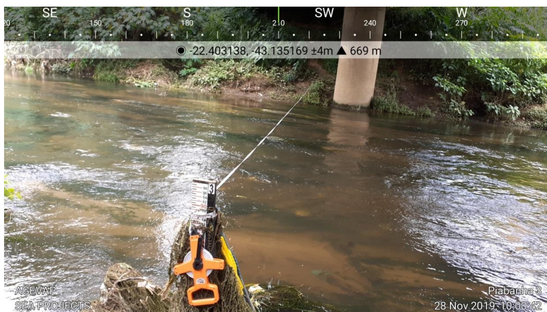
Figura 3.4-1 : Trena esticada na seção do Ponto 3.
